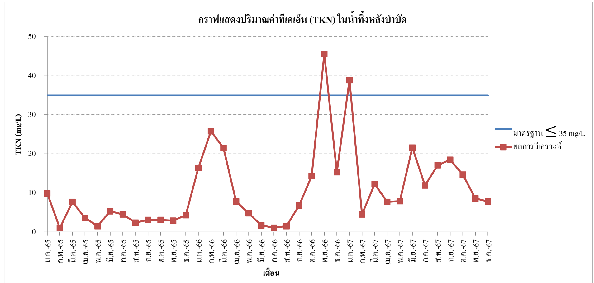
ภาพที่ 4-5 กราฟแสดงปริมาณค่าที่เคเอ็น (Total Kjeldahl Nitrogen) ในน้ำทิ้งหลังบำบัด
